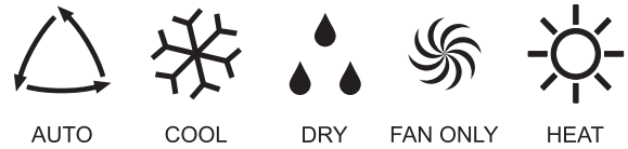
Fig. 7.6 Modos de funcionamiento.
