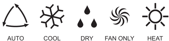
Fig. 7.11 Modos de funcionamiento.
