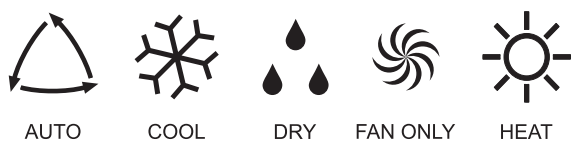
Fig. 7.9 Modos de funcionamiento.
