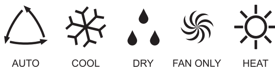
Fig. 7.14 Modos de funcionamiento.
