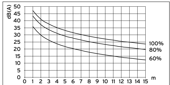
Fig. 6.1 Nivel de presión acústica de una unidad exterior en dB(A) en función de la distancia y el número de revoluciones del ventilador para VWL 62/3 S en instalación en campo libre
