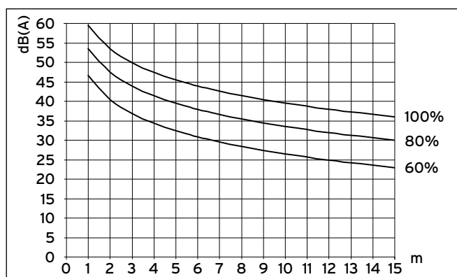
Fig. 6.3 Nivel de presión acústica de una unidad exterior en dB(A) en función de la distancia y el número de revoluciones del ventilador para VWL 102/3 S en instalación en campo libre
