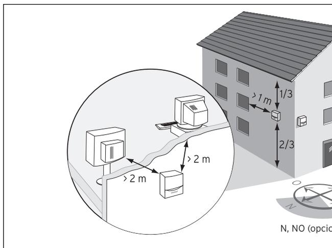
Fig. 3.8 Conexión del cable del receptor DCF
