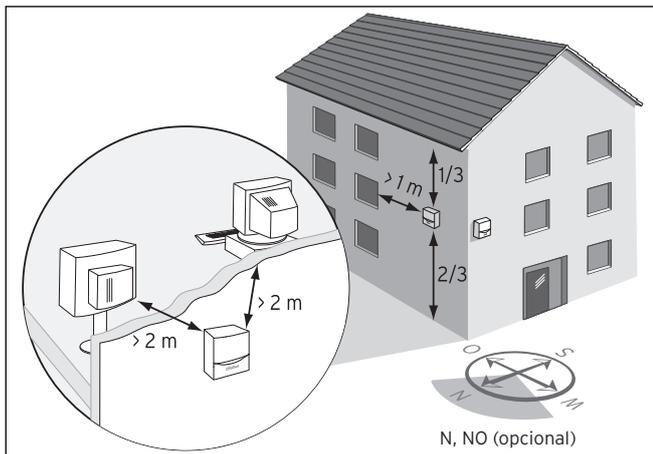
Fig. 3.6 Lugar de instalación del receptor DCF con sonda exterior integrada
