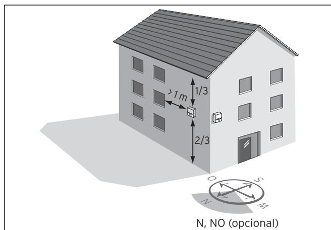
Fig. 3.9 Lugar de instalación del sensor de temperatura exterior VRC 693
