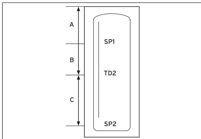
Fig. 4.36 Disposición de los sensores SP1, TD2 y SP2 en el acumulador intermedio
