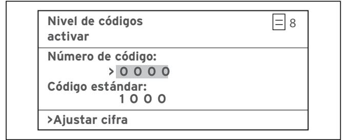
**Fig. 6.24 Activar el nivel de instalador**
