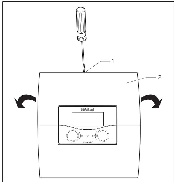
Fig. 3.3 Abrir instalación de pared
