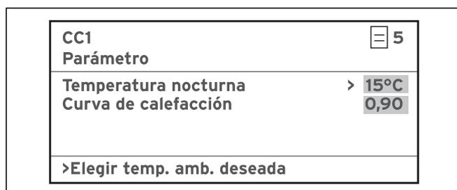
Fig. 6.20 Parámetros de la temperatura de descenso y la curva de calefacción
