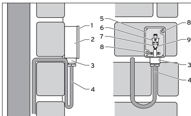
Fig. 3.10 Montaje de la sonda exterior y posición de montaje
