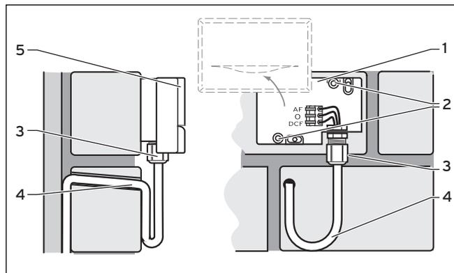
Fig. 3.7 Posición de montaje del receptor DCF
