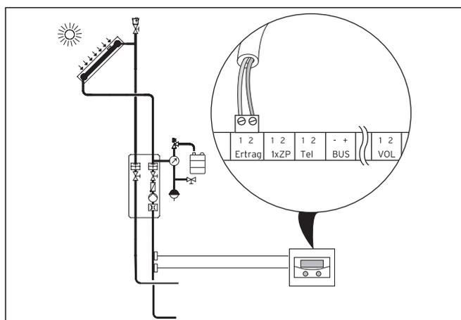
Fig. 4.31 Conexión de la sonda de retorno
