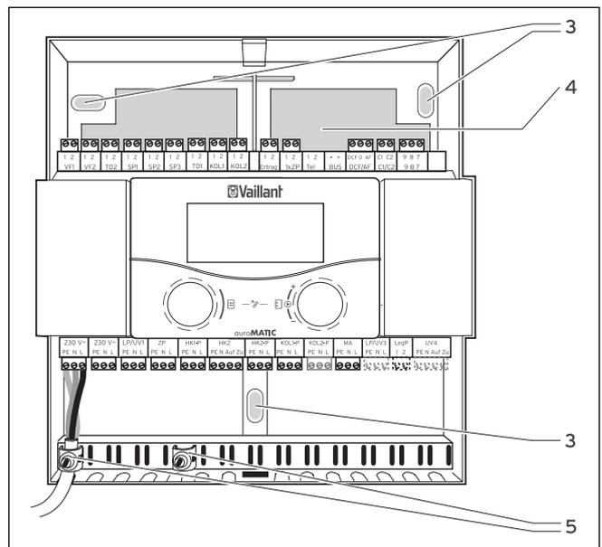
Fig. 3.4 Montaje de la instalación de pared
